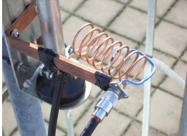
Abb. 25: Die Parallelkreis-Anpassung des vertikalen Halbwellenstrahlers nach der Reparatur, Abdeckung entfernt.
