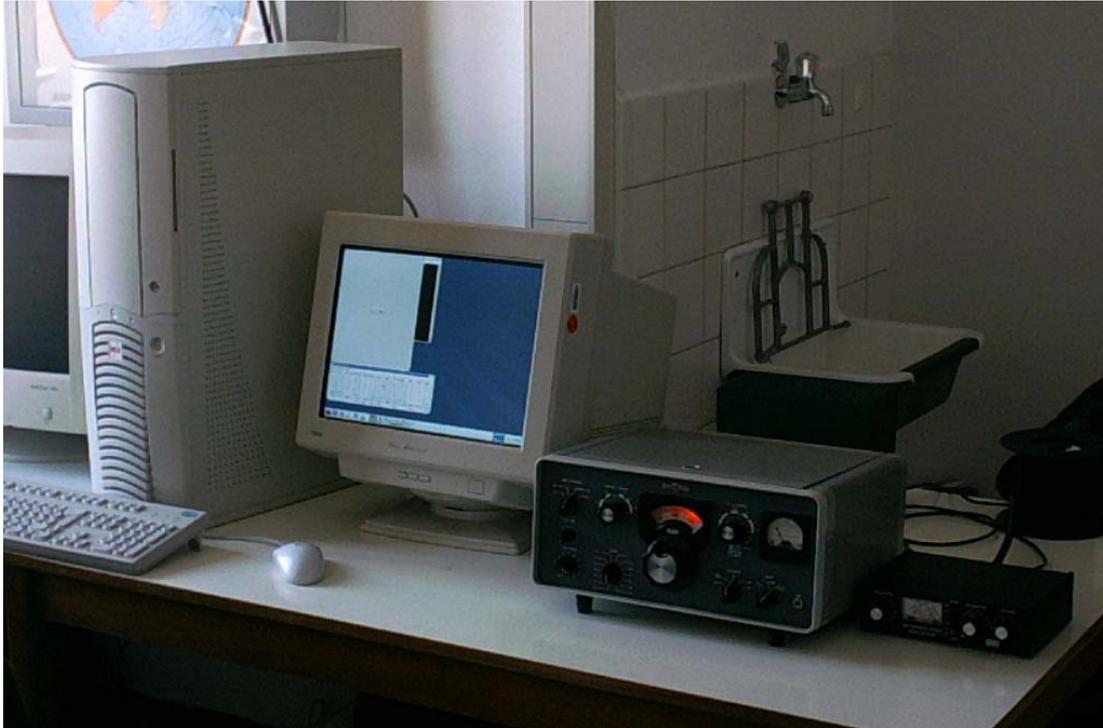
*Abb. 9: Komplette Anordnung des Senders: PC, modifizierter Sender, Antennenanpaßgerät*
