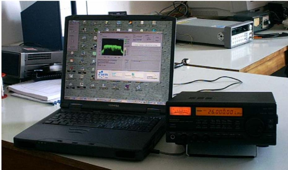
Abb. 28: Modifizierter Yaesu FRG 100- Empfänger, Dekodierung mit DRM-Software Radio auf dem Notebook-PC.
