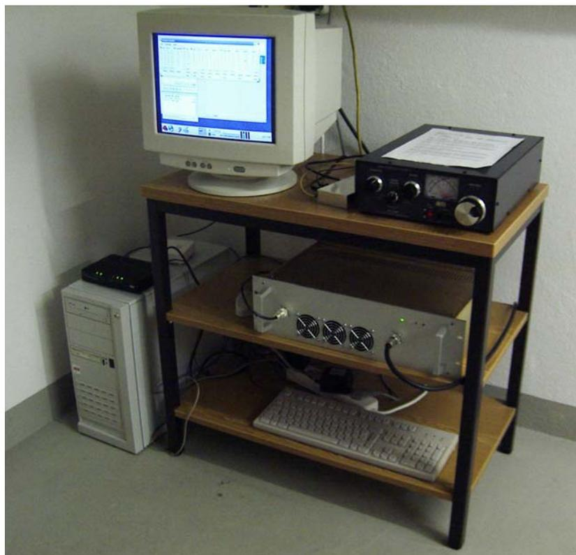
Abb. 21: Der DRM-Sender auf dem Dillberg. Links der PC zur Signalerzeugung, darauf das DSL-Modem, mit dem das Signal des Campus Radio vom Webserver der FH abgerufen wird. Rechts oben das Antennenanpassgerät, links davon der Steuersender, darunter die Transistorendstufe.
