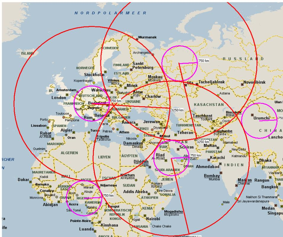
Abb. 67: Gebiete, in denen ein Kanal des 26 MHz-Bereichs verwendet bzw. nicht verwendet werden kann, wenn gegenseitige Störungen der Sender untereinander vermieden werden sollen.
