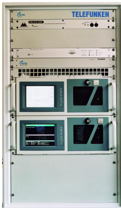
Abbildung 6: DRM Sender von Telefunken SenderSysteme Berlin mit Fraunhofer DRM ContentServer
